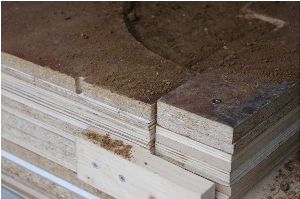
Figure 69 : Photo : Décalage des deux parties du moule sous la pression du compactage malgré le serrage. Source : photo de l'autrice.
