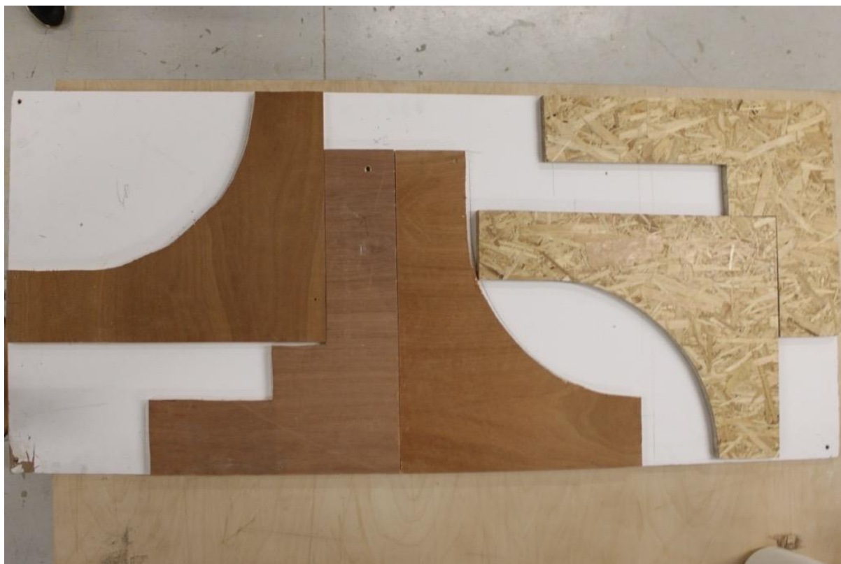
Figure 56 : Photo : Reproduction des formes et découpe des différentes plaques composant le futur moule, à partir des gabarits préalablement réalisés. Source : photo de l'auteure.
