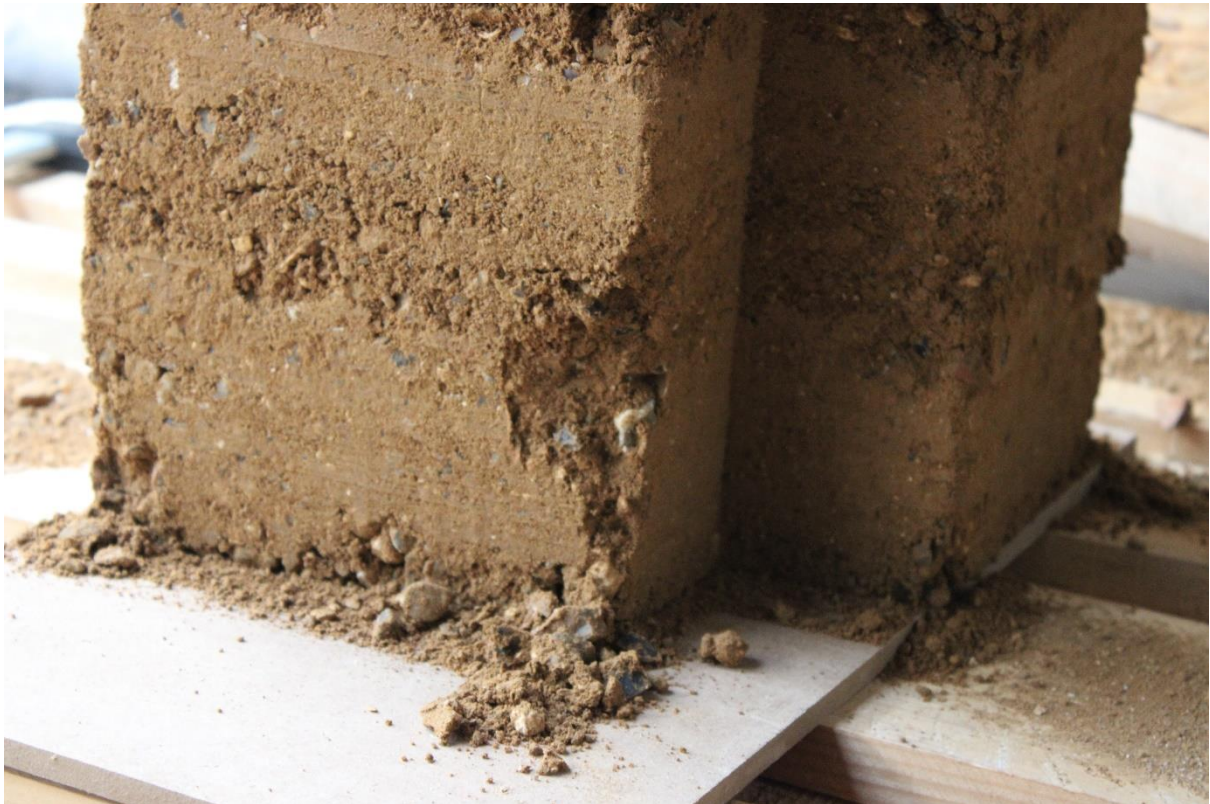
Figure 68 : Photo : Coin d'un module en pisé abîmé lors d'un démoulage mal exécuté, causant un léger éclatement de la matière. Source : photo de l'autrice.
