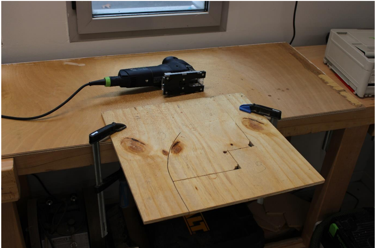
Figure 55 : Photo : Découpe du patron dans la plaque de bois à l'aide d'une perceuse et d'une scie sauteuse, la pièce étant maintenue par des serre-joints. Source : photo de l'auteure.
