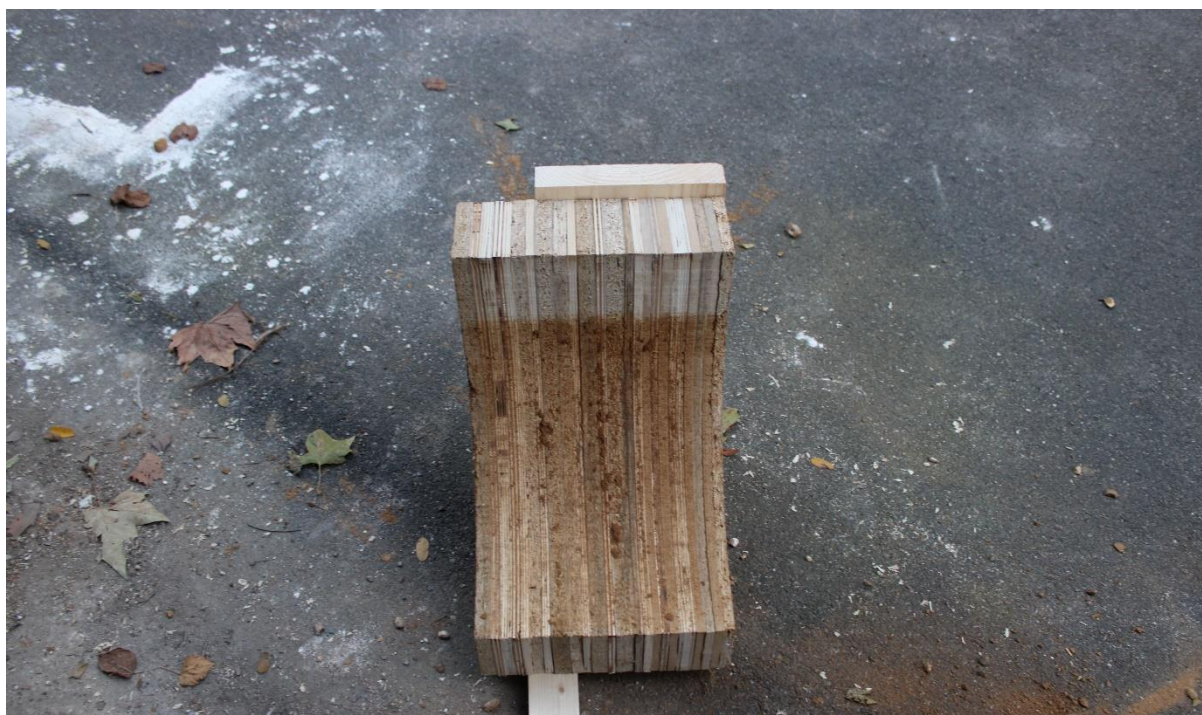
Figures 58 et 59 : Photos : Ensemble des formes en bois découpées puis assemblées par vissage pour constituer le moule final de 31 cm de hauteur. Deux tasseaux latéraux y sont ajoutés pour faciliter l'emboîtement et garantir la précision du montage. Source : photos de l'autrice.
