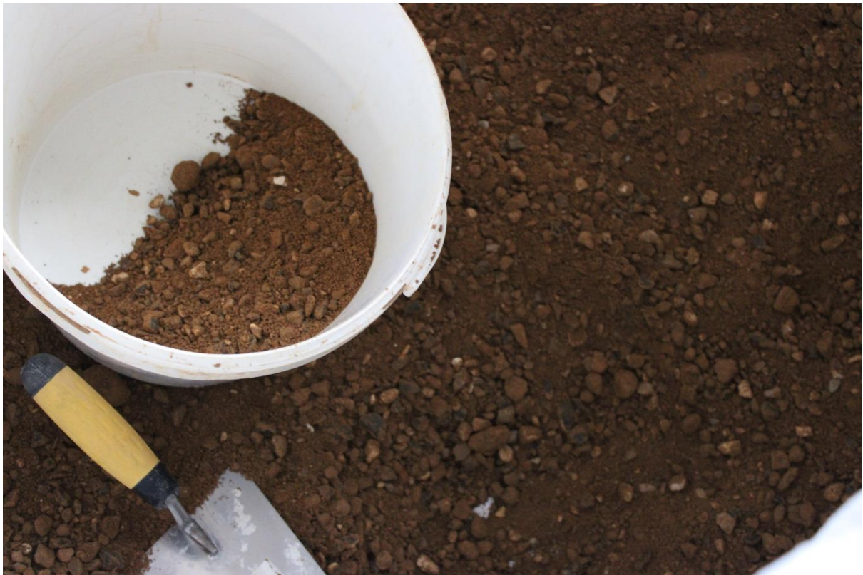
Figure 61 : Photo : Terre de pisé achetée à la Briqueterie DeWulf, avant tout tamisage. Source : photo de l'autrice.
