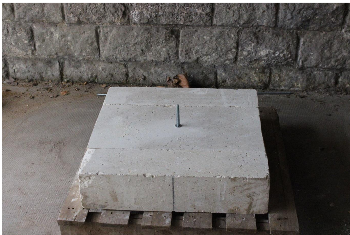
Figure 73 : Photo : Assemblage des blocs de pierre sur une palette, avec le goujon d'ancrage déjà implanté dans le bloc central. Source : photo de l'autrice.
