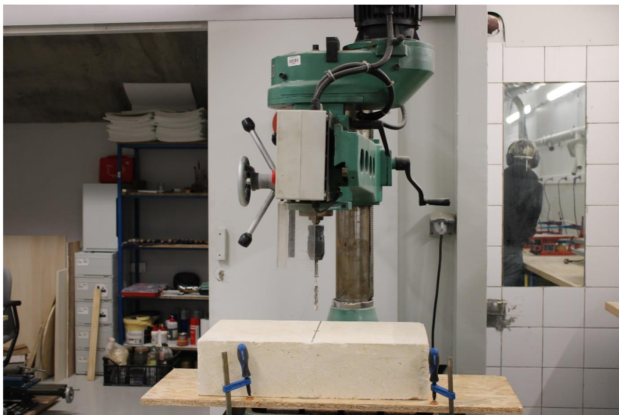
Figure 72 : Photo : Perçage, à l'aide d'une perceuse à percussion, du bloc de pierre destiné à accueillir le goujon d'ancrage inox M12 × 180 mm du poteau en bois. Source : photo de l'autrice.
