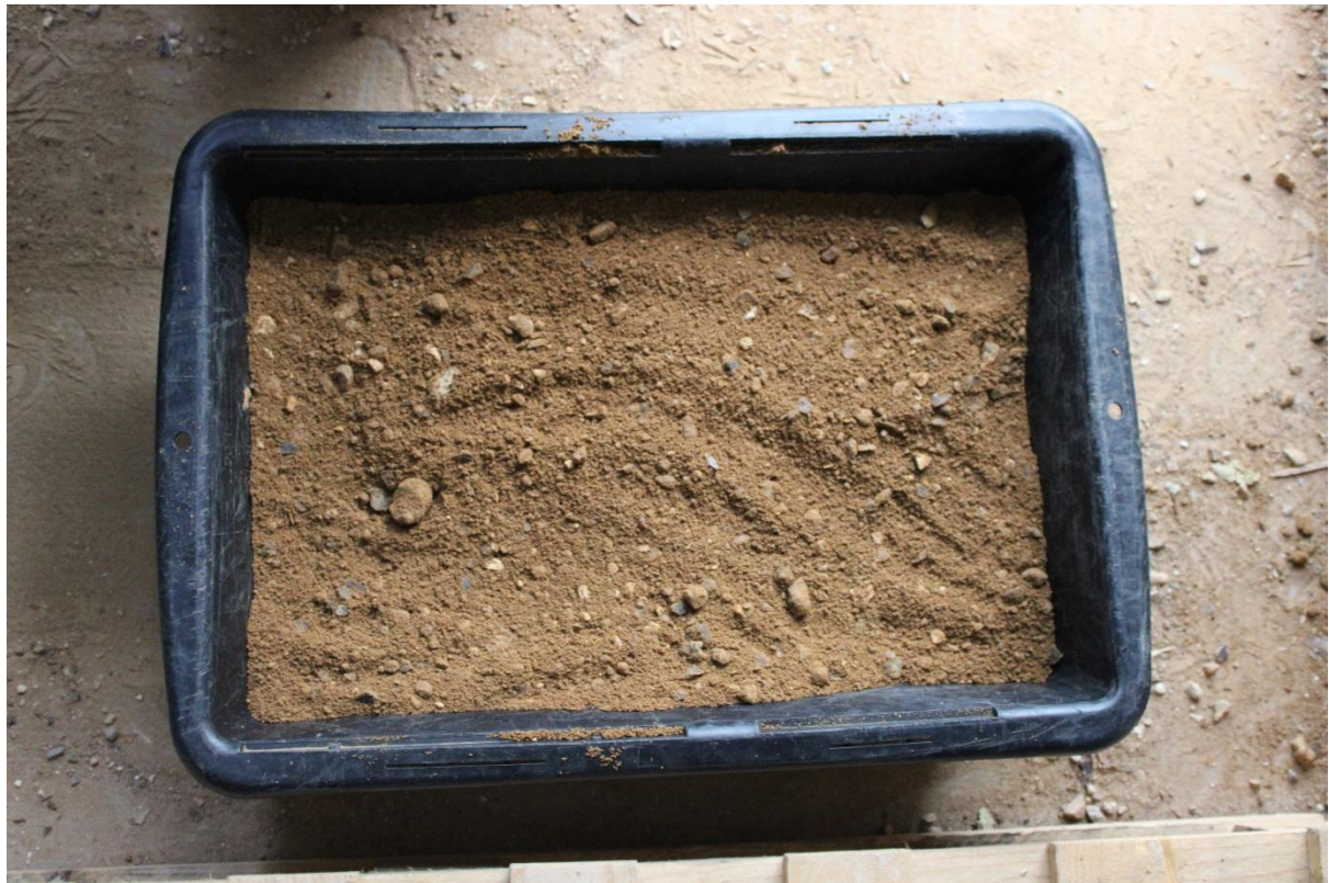
Figure 62 : Photo : Terre de pisé prête à l'emploi, composée d'un mélange de 50 % de terre tamisée et 50 % de terre brute. Source : photo de l'autrice.
