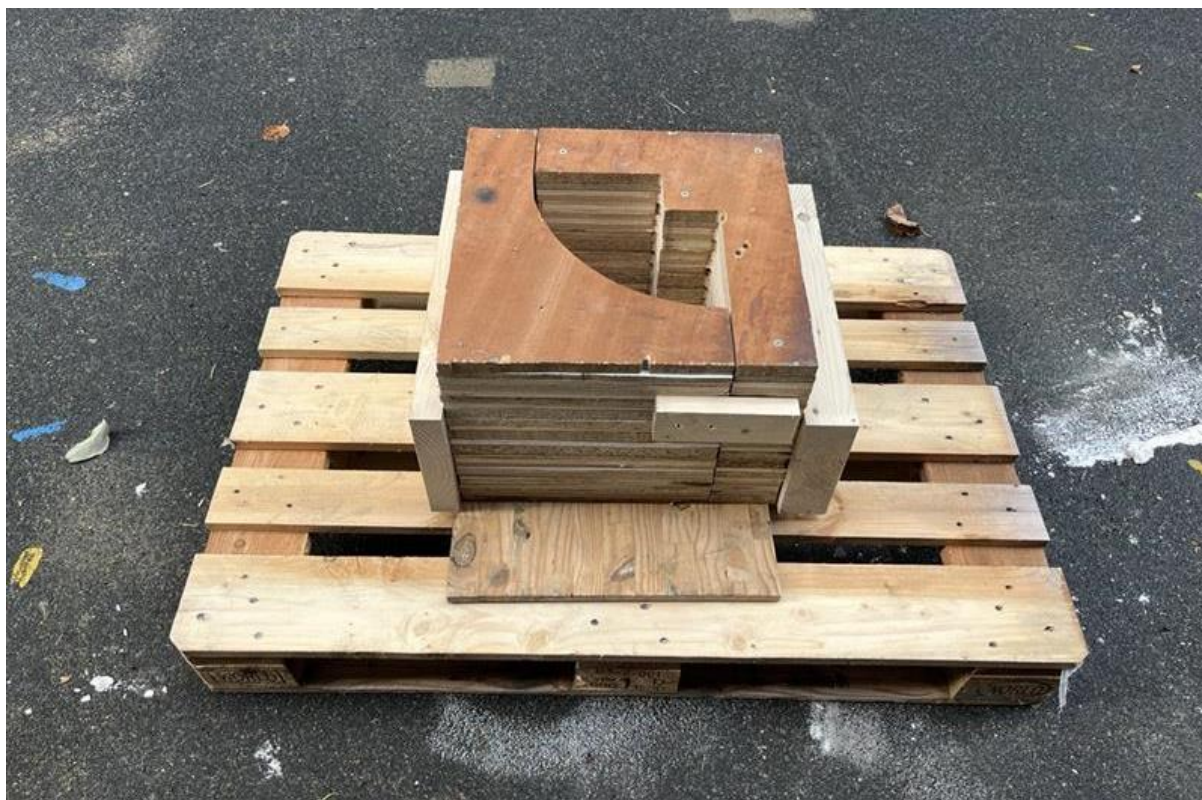
Figure 60 : Photo : Mise en place du moule final sur palette, maintenu par deux tasseaux latéraux et des serre-joints afin de reproduire le grand moule à partir du prototype. À droite, la terre prête à être mise en œuvre. Source : photo de l'autrice.
